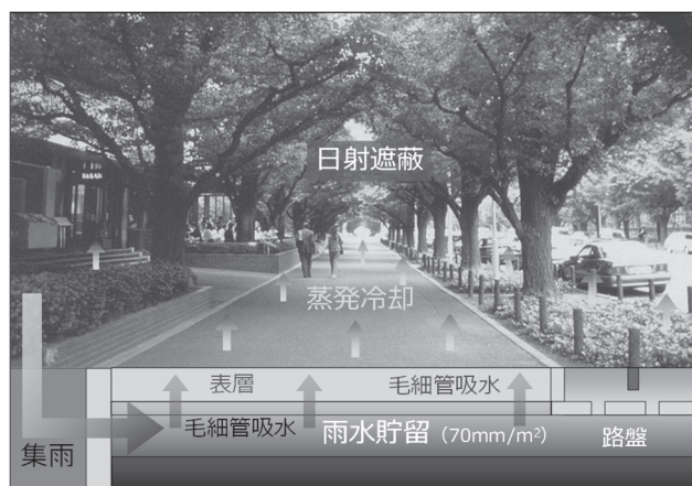
図1 蒸発冷却舗装システムを利用した理想的な屋外空間イメージ 2)
