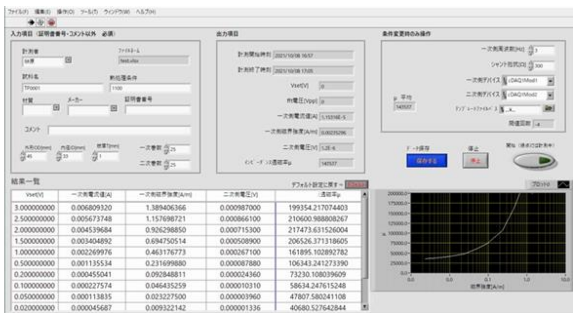
図 4.9 計測システムのユーザインターフェース 画面上部で計測条件を設定し、計測が開始されると左下に順次計測結果が数値で表示され、また同時に \mu_a - \Delta H 曲線が描かれる。
