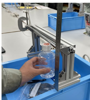
(a) たわみ計測の様子。PETボトルを手で持って荷重をかけるところ。この後手を離し、はりの左端の固定端からの水平距離と、元のはりの位置からの下がり方をノギスで計測した。 (受講生を写真撮影したもの)
